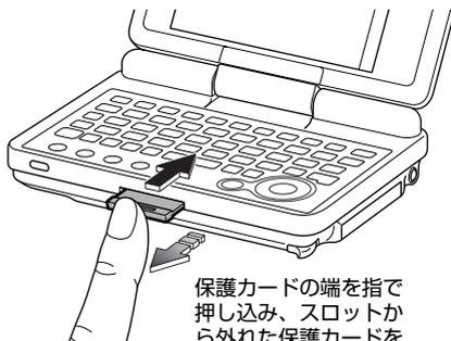
保護カードの端を指で押し込み、スロットから外れた保護カードを抜き取ります。
