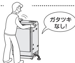
調節脚だけで調節できない場合や、設置方法Bで脚スペーサーが必要な場合は、固定脚を脚スペーサー(別売品)で調節してください。
