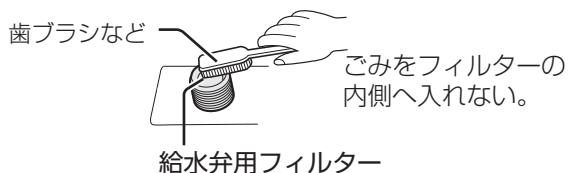
給水弁用フィルターは必ず取り付ける。
