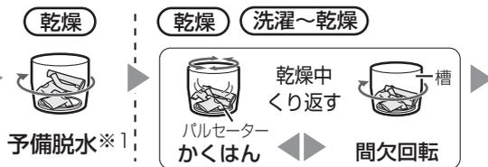
温風を吹き込みながら、パルセーターと槽を交互に回転させる。
