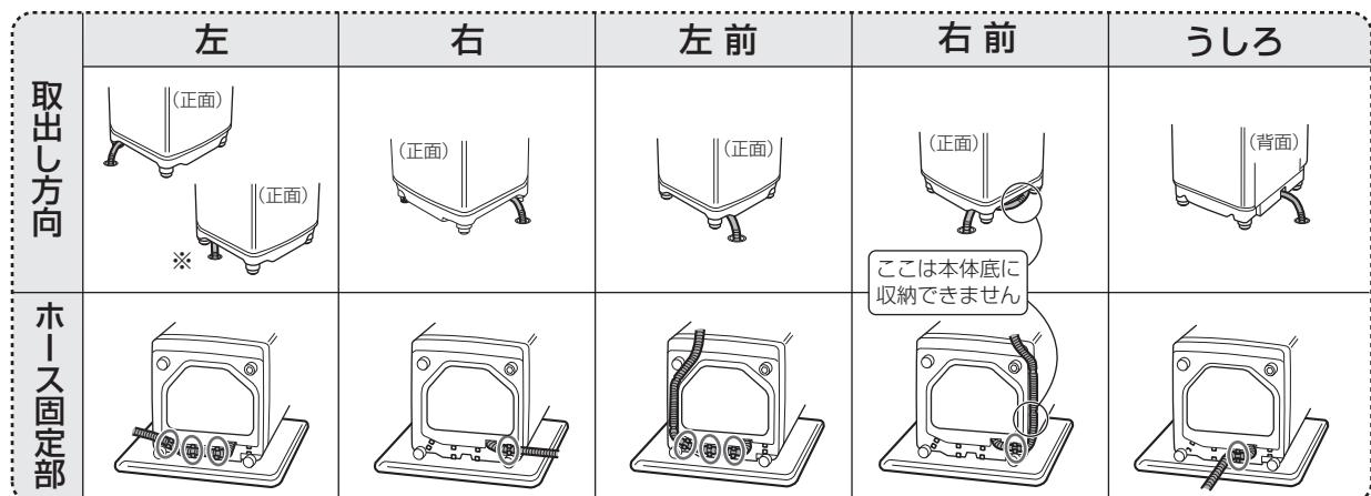
※設置場所がせまい場合、左側面などは、排水口が底面の溝部に位置するように、本体を寄せられます。
