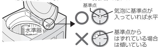
水平調節のしかた(気泡がはずれている方向と反対の脚を高くする)
