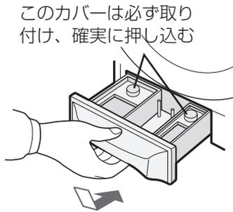
このカバーは必ず取り付け、確実に押し込む
