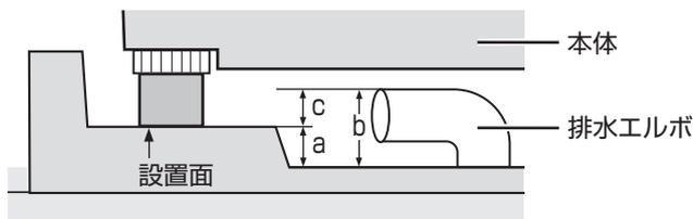
左図の「排水エルボの高さ(b)」から「防水パンの底面から設置面までの高さ(a)」を引いた「c寸法(c = b - a)」が15mm以上ある場合は、排水ホースと本体のすき間を確保するため、本体の高さ調整が必要です。下表を参考に、別売の「脚スペーサー」または「据付脚」で調整してください。
