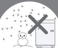
蛇口を閉めて給水ホースをはずし、ホースと槽内の水を十分に排水する。
