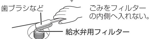
給水弁用フィルターは必ず取り付ける。
