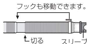
**2** 設置場所が狭い場合、左側面などは、排水口が底面の溝部(ガイドの外側)に位置するよう、本体を寄せることができます。
