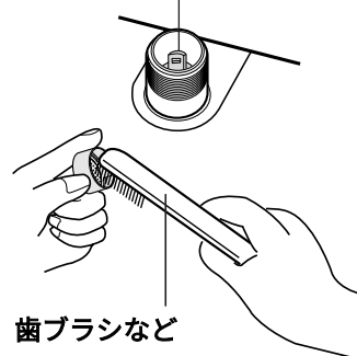
給水弁フィルター
