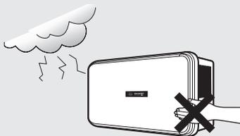
**パワーコンディショナ付近に湯気、水蒸気、冷気、油煙、腐食性ガスを出す機器を置かない。**
