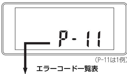
太陽電池パネルの出力電圧が規定値を超えたため、パワーコンディショナの運転を停止しました。
