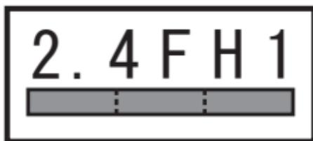
この無線機器は 2.4GHz 帯を使用します。変調方式として FH-SS 変調方式を採用し、与干渉距離は 10m です。
