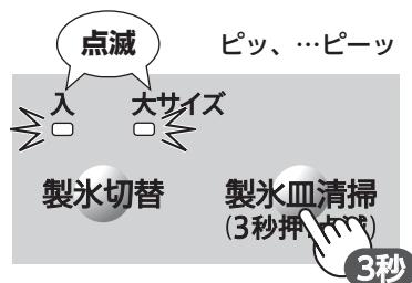
(約80秒間)給水タンクから製氷皿に給水し、製氷皿から貯氷ケースに排水
