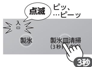
（約80秒間）給水タンクから製氷皿に給水し、製氷皿から貯氷コーナーに排水
