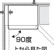
図は必要最小設置寸法です。(消費電力量測定時の寸法とは異なります)
