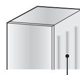
側面の放熱用パイプによる凹凸
