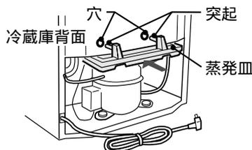
1 蒸発皿を右図の位置に水平に差し込む。蒸発皿のツメを確実にツメ台にのせてください。
