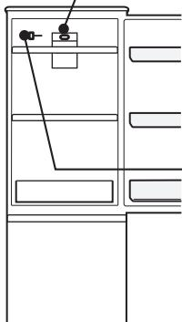
冷凍室温度つまみ つまみを切り替えることで、冷凍室に送る冷気の量を調節します。
