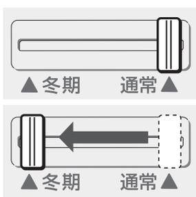
この冷蔵庫は冷蔵室温度に合わせて、冷却運転をします。冬場は冷蔵室温度があまり上昇しないので、冷却運転時間が減り、冷凍室温度が上昇する傾向にあります。「冬期」モードにすると、冷凍室へ送る冷気の割合が増えます。
