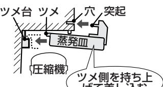
2. 突起を冷蔵庫背面の穴に押し込む。
