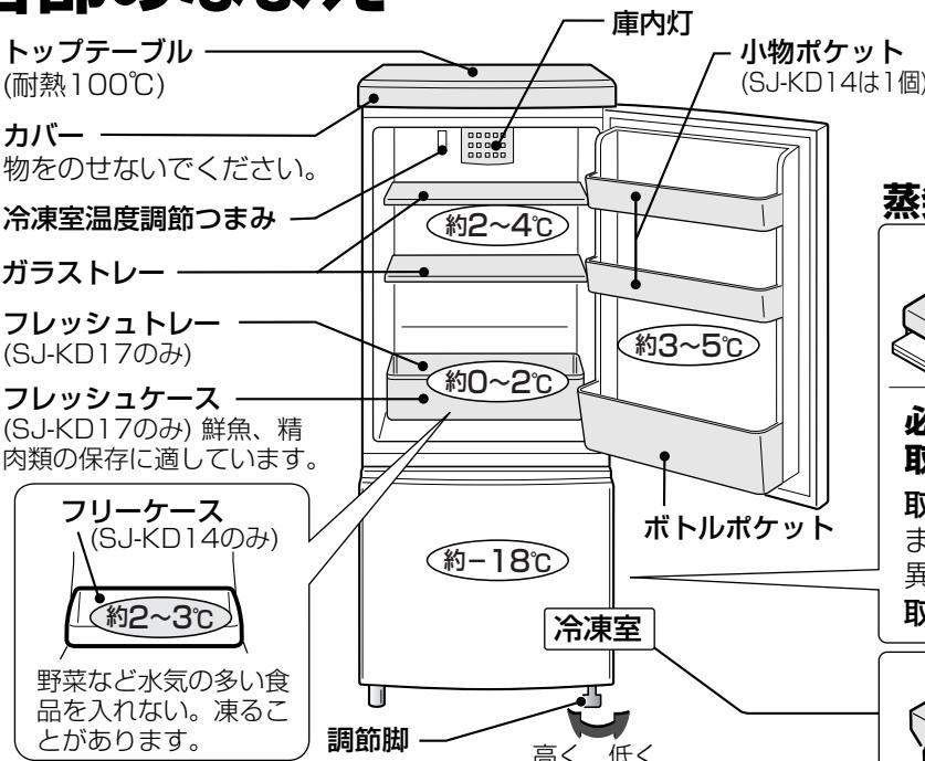
\*図中の温度は、周囲温度30°C温度調節通常位置で、食品を入れずにドアを閉じ、温度が安定したときの目安の温度です。
