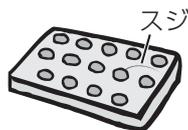
樹脂材料の合流箇所や、金型の接合部が、スジのように残ったもの。
