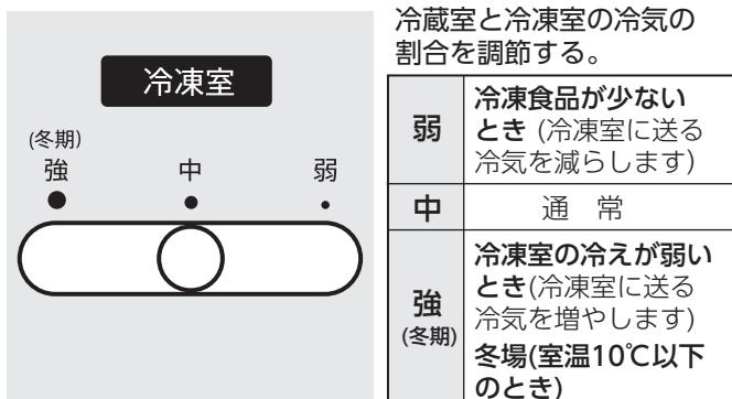
冷蔵室と冷凍室の冷気の割合を調節する。
