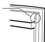
製造工程での側面の波打ちや歪み(照明の当たり方などにより見えることがあります)
