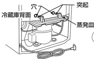
① 蒸発皿を図の位置に水平に差し込む。
