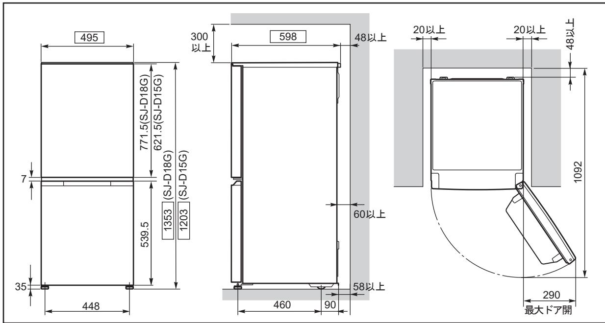
電子レンジをのせて使うときは、電子レンジの脚間寸法(外側)が幅410mm×奥行340mm以内を目安としてください。
