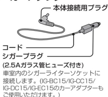
車室内のシガーライターソケットに接続します。(IG-BC15/IG-CC15/IG-DC15/IG-EC15のカーアダプターもご使用いただけます。)
