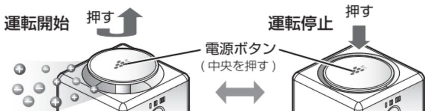
運転開始時の運転モードは、前回運転を停止した運転モードで運転を再開します。
