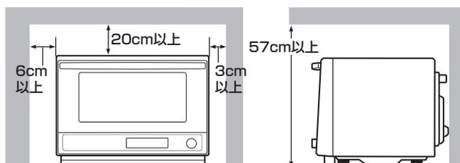
上記の記載寸法を離しても、排気に調理中の油や湯気が混じり、排気口付近の壁が汚れたりすることがあります。壁の汚れが気になる場合は、壁面にアルミホイルなどを貼ることをおすすめします。製品に貼らない
