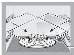
■スチームカップの水を加熱し、蒸気を発生させて、食品表面の乾燥をおさえながら加熱します。
