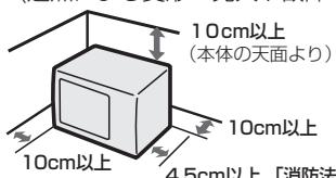
この製品は、「消防法 設置基準」に基づく試験基準に適合しています。壁の材質などによって、排気口付近の壁が汚れたり、結露することがあります。壁の汚れや結露が気になる場合は、左記記載の寸法以上離したり、壁面にアルミホイルなどを貼ることをおすすめします
