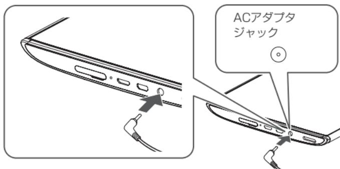
充電が始まると、本製品の前面にあるバッテリー状態ランプがオレンジ点灯します。満充電になるとバッテリー状態ランプが緑点灯に変わります。
