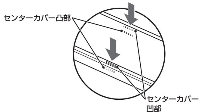
3 センターカバー固定を図の矢印方向にスライドさせて固定する。
