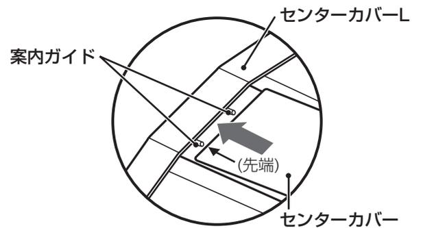
2 センターカバーの中央部の両サイドを図の矢印方向(天井方向)へ押し込む。
