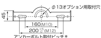
\*M12アンカーボルトの場合は取付ピッチ200mm
