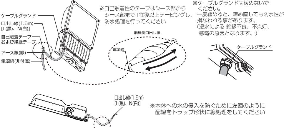
※本体への水の侵入を防ぐために左図のように配線をトラップ形状に線処理をしてください
