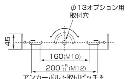
\* M12アンカーボルトの場合は取付ピッチ200mm
