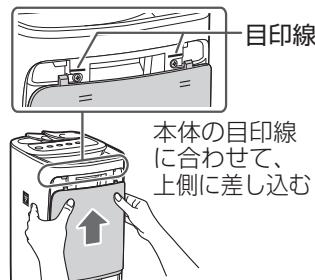
本体の目印線に合わせて、上側に差し込む
