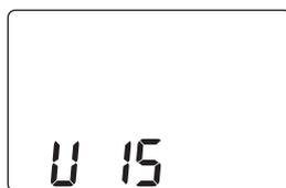
製品内部の水が凍結して、水を使う加熱ができません。
