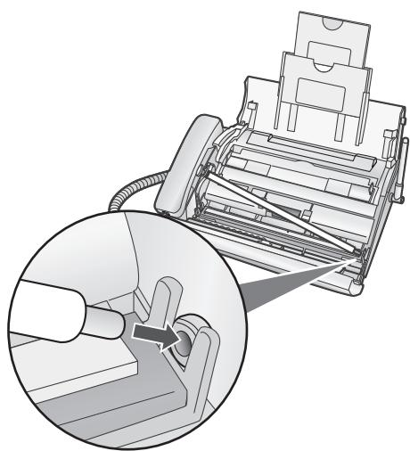
原稿送りローラーは必ず正しく取り付けてください。取り付けが不完全なまま操作パネルを閉めると、親機が破損する原因になることがあります。
