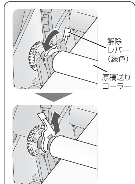
ご注意：原稿送りローラーは、ローラー部分と端のギヤ部分、解除レバーを分解しないでください。
