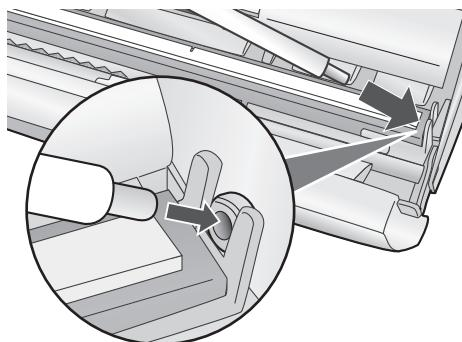
原稿送りローラーは必ず正しく取り付けてください。取り付けが不完全なまま操作パネルを閉めると、親機が破損する原因になることがあります。また、取り付けが不完全だったり、はずしたままお使いになると、コピーやファックス送信ができません。
