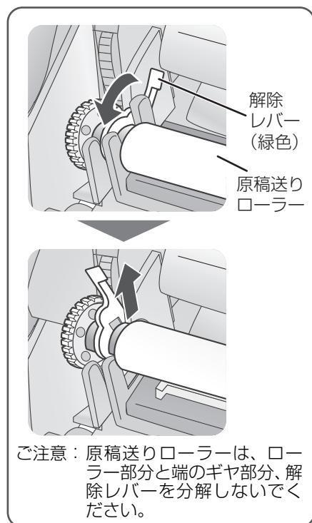
ご注意：原稿送りローラーは、ローラー部分と端のギヤ部分、解除レバーを分解しないでください。
