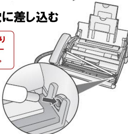
**5** 原稿送りローラーの左端を戻し、**[解除レバー]**を後ろに戻す
