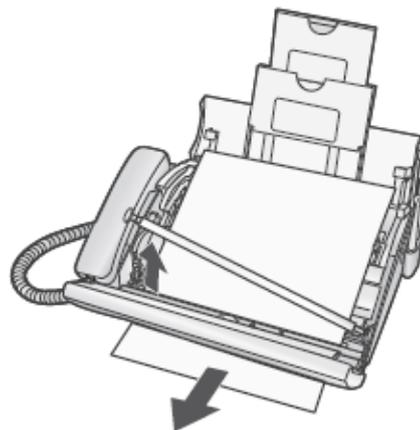
**4** 原稿送りローラーの右端を穴に差し込む
