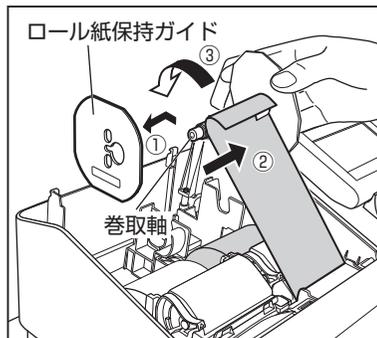
**ご注意** ⚠️ ロール紙保持ガイドを取り外したり取り付けるときは、ロール紙保持ガイドを巻取軸に対して垂直方向にまっすぐ動かしてください。このとき、動かす方向がずれると、ロール紙保持ガイドに無理な力が加わり、ロール紙保持ガイドが破損する場合があります。
