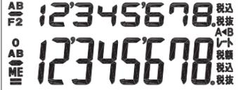
マルチ換算：液晶表示部の上段に換算前の値、下段に換算後の値を同時表示
