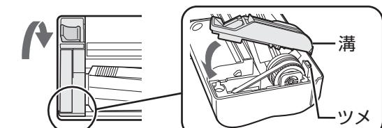
④ 開閉レバーを矢印の方向にスライドさせる
