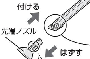
ブラシを戻した状態で先端ノズルを付ける。
