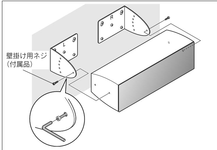
4. センタースピーカーの角度を調整して、付属の壁掛け用ネジ(2本)を使ってしっかりと固定します。
