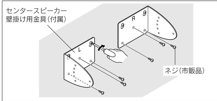
3. 付属の壁掛け用ネジ(2本)を使って、センタースピーカーの左右を固定します。
