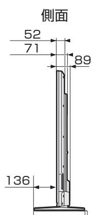
壁掛け金具取り付け時の寸法
