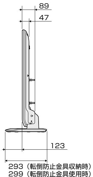
壁掛け金具取り付け時の寸法
