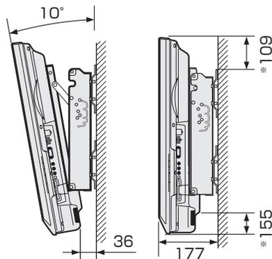
壁掛け金具AN-37AG4の壁用金具Bには、画面の中心を示す表示「B」があります。画面の中心を示す「B」より29mm下がディスプレイの中心です。
