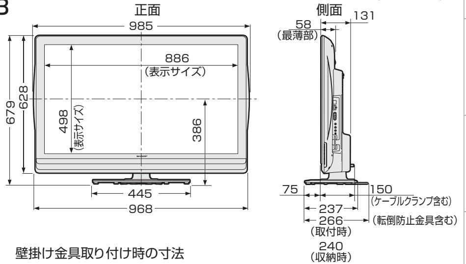
壁掛け金具取り付け時の寸法
