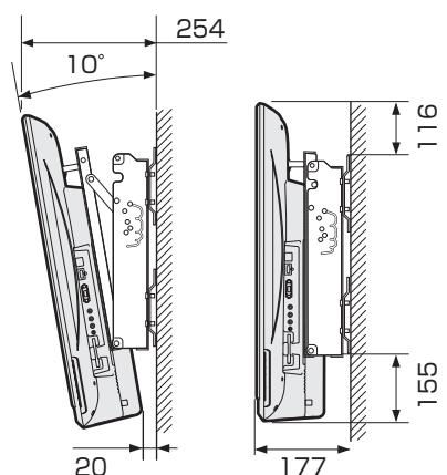
壁掛け金具AN-37AG4の壁用金具Bには、画面の中心を示す表示「B」があります。画面の中心を示す「B」より29mm下がディスプレイの中心です。
