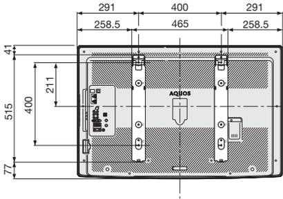
壁掛け金具AN-52AG6の壁用金具の「d」の表示がディスプレイの中心です。
