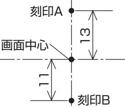
・壁掛け金具AN-37AG2の刻印と画面中心位置の関係は、刻印Aから13mm下、刻印Bから11mm上が画面中心です。
