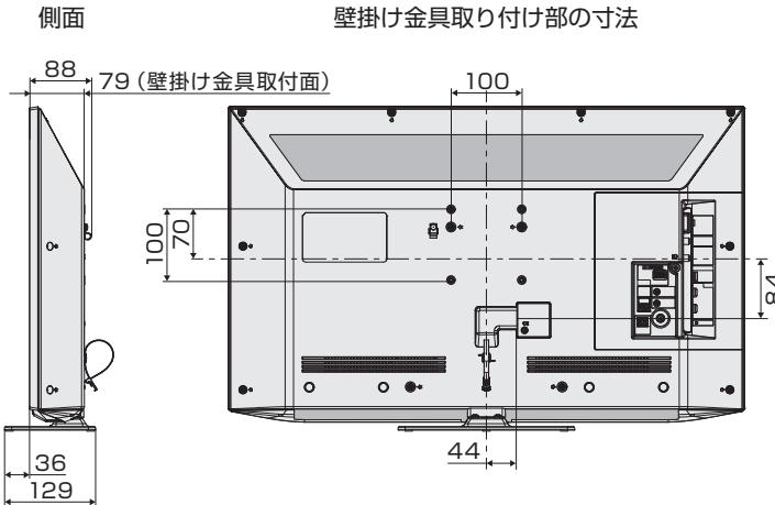
壁掛け金具取り付け部の寸法
