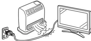
電源コードの被覆が溶けて火災・感電の原因となることがあります。
